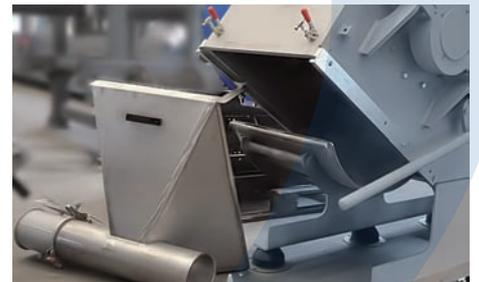
El diseño de las máquinas GSE permite rápido y fácil acceso a la cámara de corte para su mantenimiento y limpieza.
