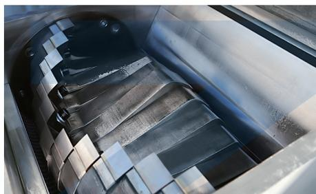
Les lames rotors décalées créent une coupe séquentielle, ce qui augmente le couple de broyage. Toutes les machines de la gamme GSL sont adaptées aux matériaux solides et souples.
