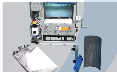
Grâce au système « Ouverture Rapide » de ZERMA utilisé sur la série GSL, ces machines peuvent être ouvertes rapidement pour le nettoyage et la maintenance sans la nécessité d'outils particuliers/spéciaux.
