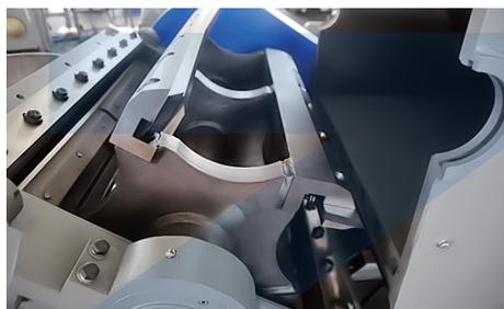
Les broyeurs de la gamme GSE sont disponibles avec différentes options de rotor pour s'adapter à de différentes applications, tous les rotors dotés de la technologie coupe en "V" pour un broyage de haute qualité.
