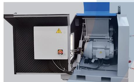
Afin de minimiser l'espace au sol nécessaire et pour rendre la machine facile à déplacer, les commandes et l'armoire électrique sont intégrés dans l'insonorisation.
