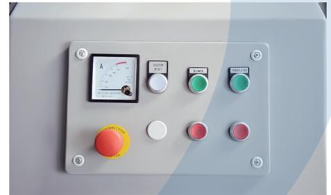
Afin de minimiser l'espace au sol nécessaire et pour rendre la machine facile à déplacer, les commandes et l'armoire électrique sont intégrés dans l'insonorisation.
