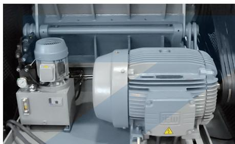
Pour rester dans la même état d'esprit d'une gamme compacte, l'ouverture est motorisée et hydraulique pour atteindre le caisson d'insonorisation.
