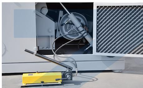
Pour garantir une sécurité optimale, une facilité et rapidité d'accès pour le nettoyage et la maintenance pour la série 500, la chambre de coupe s'ouvre hydrauliquement.
