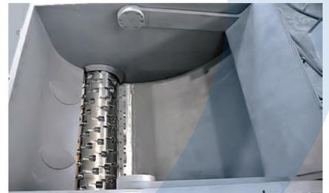
El diseño interno del empujador, en la serie ZIS, ofrece un amplio espacio en la cámara de corte y mantiene el tamaño compacto de la máquina. Por lo que son ideales para triturar piezas de gran volumen.
