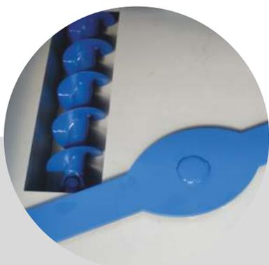
Agitador permanente con visosinfin de transporte hacia el cilindro de llenado / compresión.
