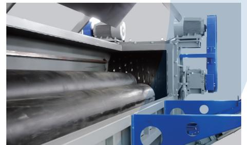
Les déchiqueteurs ZRS de tubes sont équipés d'un chargeur spécial d'une dimension permettant de prendre des tuyaux de 6 mètres de longueur. Un poussoir télescopique puissant force les tuyaux contre le rotor.
