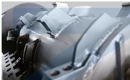
Le broyeur à marteaux ZHM dispose d'un rotor à surface plane avec des porte-outils soudés innovants. Cette conception robuste du rotor assure un bon fonctionnement sur les différents matériaux.
